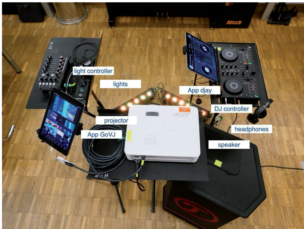
Abbildung 1: Performance-Setup bestehend aus DJ-Setup (mittig rechts), VJ-Setup (mittig/links vorne) und LJ-Setup (mittig links)
